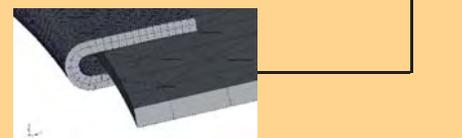
Abb. 2: Simulation eines Falzprozesses
