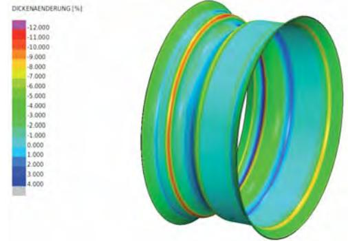
Abb. 6b: Rollrücken einer Felge
